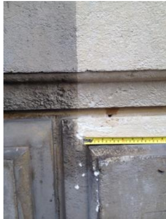
Essais de nettoyage par savon nettoyant et cataplasme d'argile
