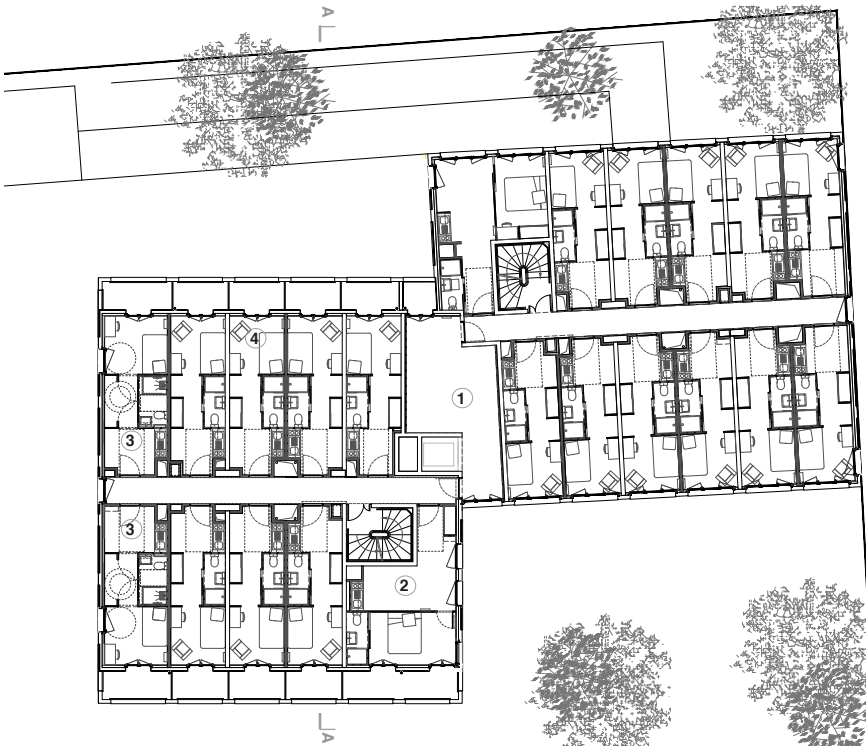
Plan R+1| Ech. originale 1:50 | 1st floor plan | original scale 1:50 1. espace de détente | 2. chambre 2P | 3.chambre PMR | 4. chambre normale 1. common space | 2. two room bedroom | 3. disabled bedroom | 4. normal bedroom
