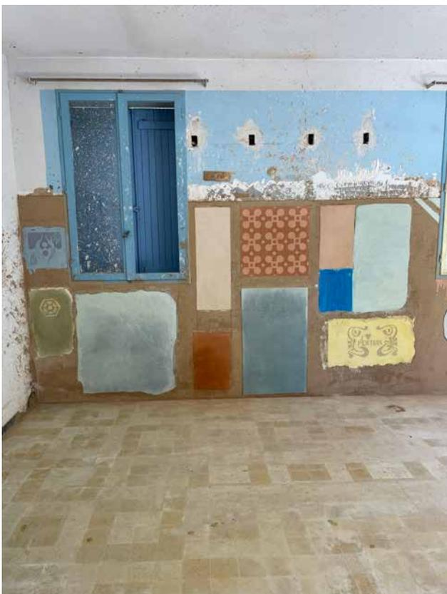
▲ Tests d'enduits de finition à la chaux et à l'argile (stuc, sgraffito)
