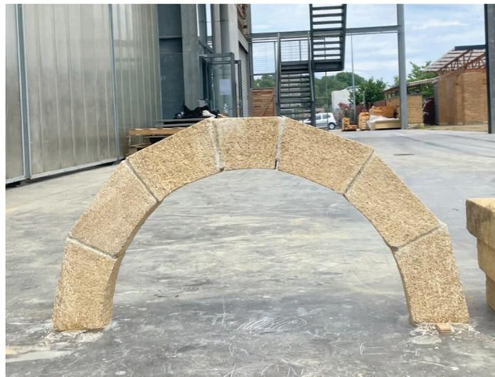
1ère phase : voûte d'expérimentation pour comprendre le fonctionnement d'une voûte.
