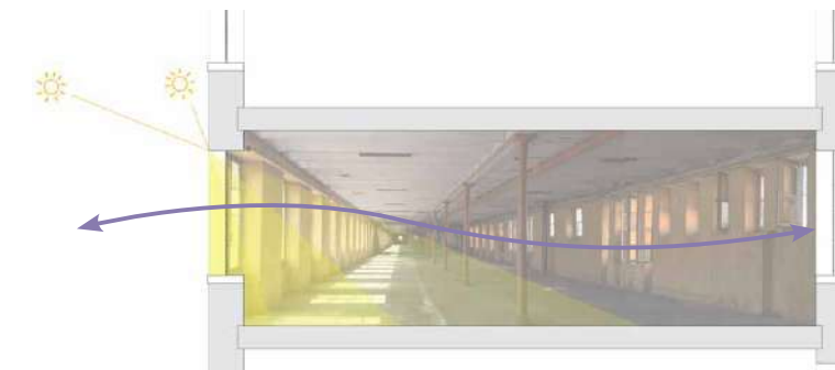
Coupe schématique des espaces caractéristiques de l'usine : des qualités favorisant la réutilisation du bâti en l'état
