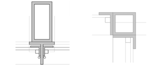
DÉTAILS - Intégration des menuiseries aux tirants. / Finesse des cadres aciers.
