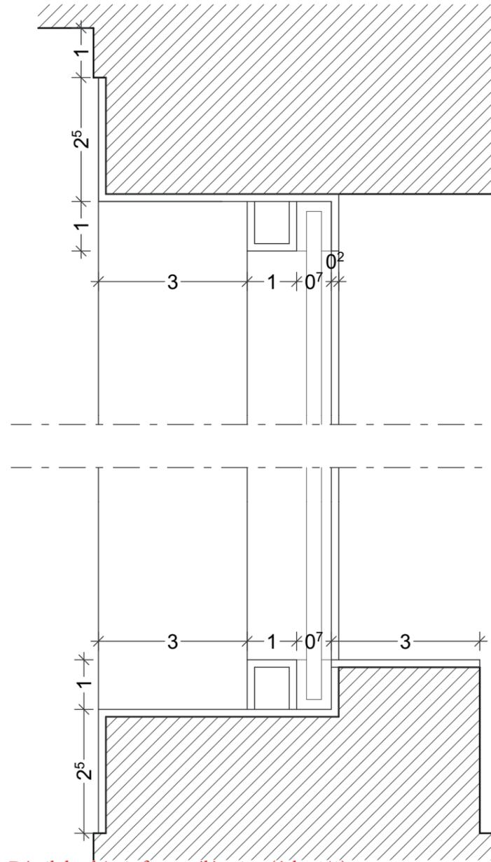
Détail du châssis fixe en élévation (éch : 1/1)
