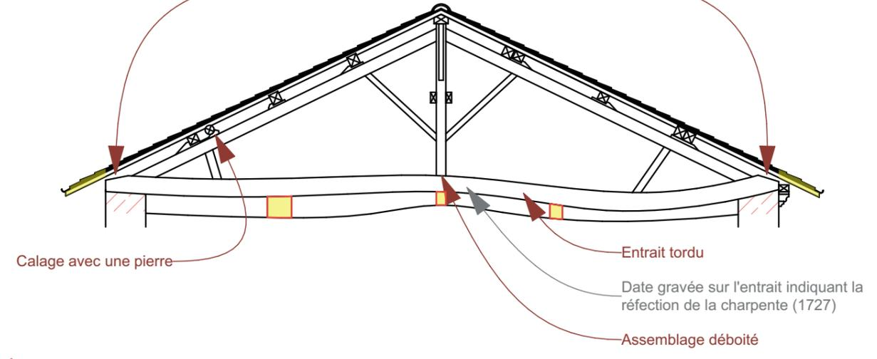
Élévation des fermes de la charpente (diagnostic)
