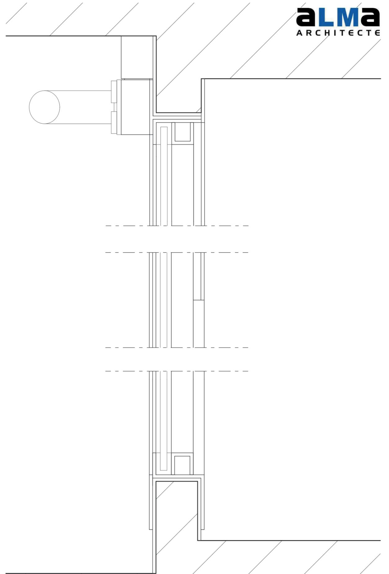
Détails de la menuiserie de la fenêtre de la sacristie en élévation (éch : 1/1)
